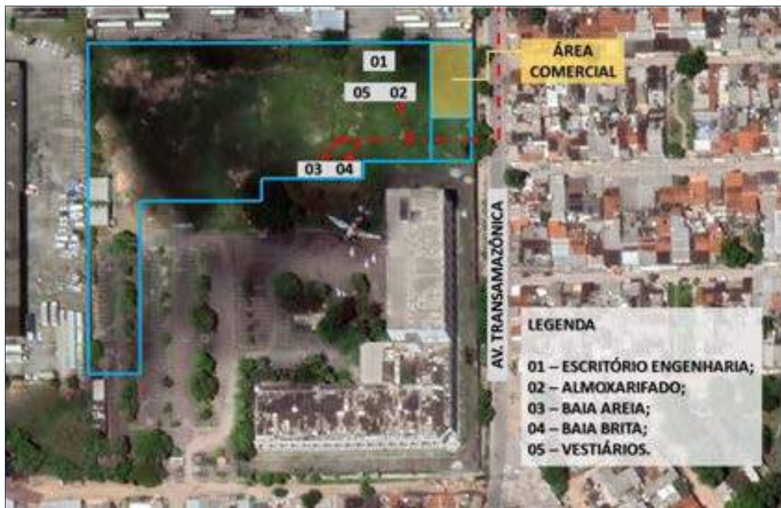
Figura 75 - Croqui esquemático do canteiro de obras com identificação das operações de carga e descarga. Fonte: CARRILHO.
