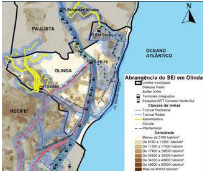
Figura 57 - Abrangência do Sistema Estrutural Integrado - SEI em Olinda. Fonte: Plamob Olinda – TECTRAN (2016).
