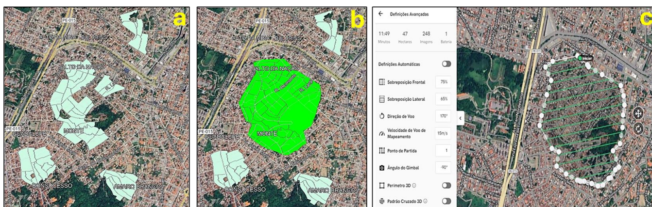
Figura 3.17: Planejamento de voo no município de Olinda - (a) mapa de setores, (b) polígono recobrimdo um conjunto de setores agrupados para ser mapeado e (c) resultado do planejamento de voo.
