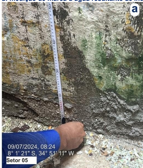
Figura 9: Fotos de campo do setor 05 - a: medição de marca d'água resultante de inundação; b: ocorrência de alagamento no momento da vistoria de campo; c: habitações próximas à costa marítima; d: medição de marca d'água resultante de inundação.
